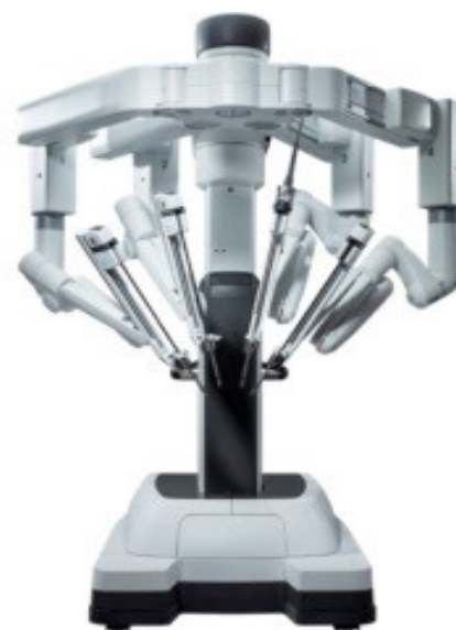
Figura 1. (A) Sistemi Da Vinci Si me krahun e tij optik qendror (diametri 12 mm) dhe 3 trokare pune, secila me diametër 8 mm (B) Sistemi Da Vinci Xi është dukshëm më i vogël me katër krahë fleksibël identikë (8 mm secili) ( https://www.sciencedirect.com/topics/engineering/vinci-system )
