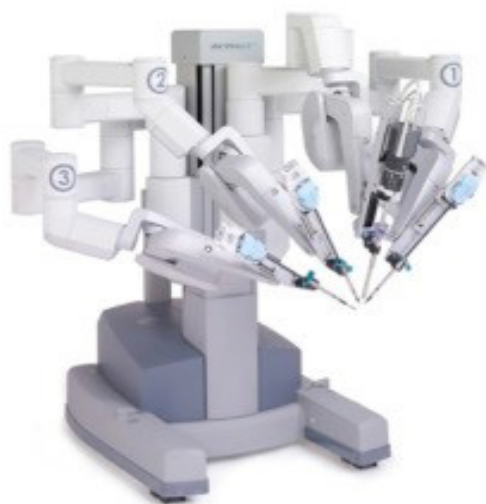
Figura 1. (A) Sistemi Da Vinci Si me krahun e tij optik qendror (diametri 12 mm) dhe 3 trokare pune, secila me diametër 8 mm (B) Sistemi Da Vinci Xi është dukshëm më i vogël me katër krahë fleksibël identikë (8 mm secili) ( https://www.sciencedirect.com/topics/engineering/vinci-system )
